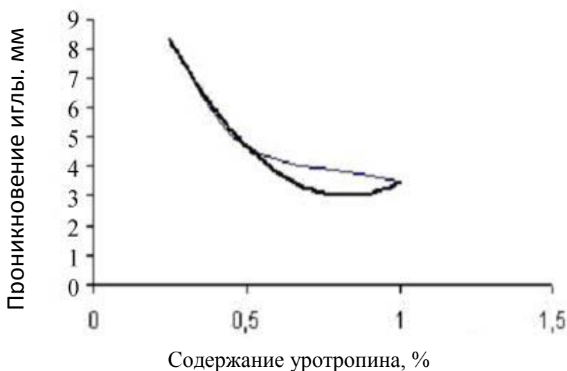
Рис. 2. Глубина проникновения иглы в зависимости от содержания ГМТА в битуме
